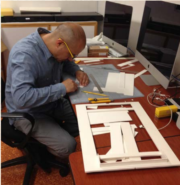
Fig. 15 y 16. Fabricación y uso del portanegativo panorámico para escaner Topaz.
