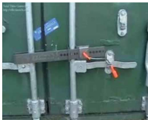
Sistema de seguridad SEALOCK utilizado en trailers y contenedores
