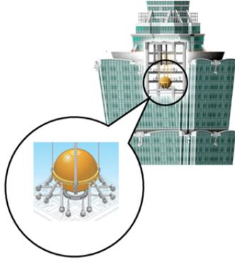
Figura 3. Absorbedor de vibración del edificio Taipei 101, Taiwan.
