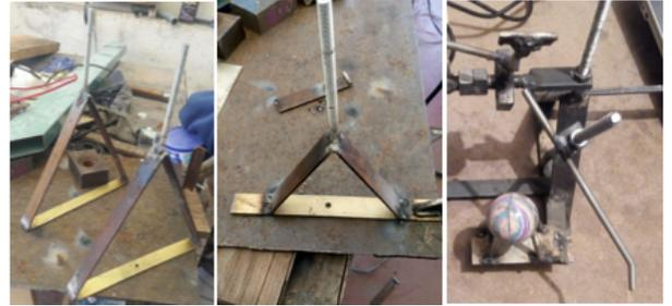
El mecanismo lanzador es de hierro y acero inoxidable, la parte de hierro está asegurada por medio de un rodamiento. A esta pieza de hierro se le soldó una barra de  $\frac{1}{4}$ " con un largo de 3.5". Sobre esta misma pieza se le colocó una barra de 3" de largo que sirve como tope del resorte. En la parte frontal se soldó una lámina cuadrada de 1", la cual hará contacto directo con el proyectil ya colocado en la base.
