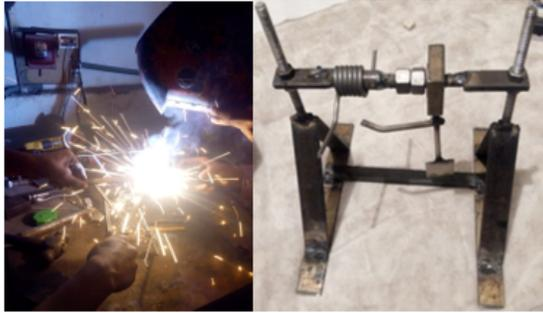
Como se comentó al principio, la soldadura utilizada para la base fue por soldadura por electrodo 60/13, pero para los elementos que delimitaban el resorte, las uniones de la pierna mecánica, y del soporte, que delimita la flexión con el esparago, se utilizó soldadura 70/18 por arco eléctrico. Esto para evitar ruptura en la soldadura.
