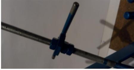
El eje en el que se fijó el resorte y la rotación de la varilla que golpea el proyectil, tiene un largo de 4". En los extremos de la misma, se soldaron 2 pedazos de solera de 1/4"x3/4" con un largo de 2". La solera ya mencionada lleva un barreno de 5/16", que permite el libre movimiento vertical de la varilla.
