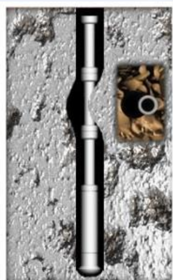
Atrapamiento lateral debido a una "pata de perro"
