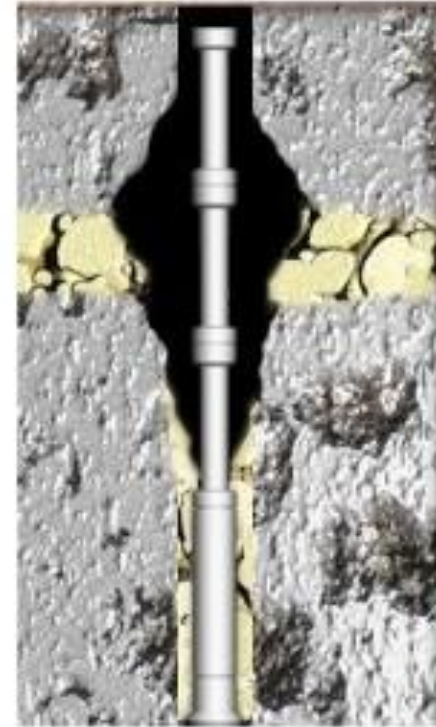
Hinchamiento y derrumbe
