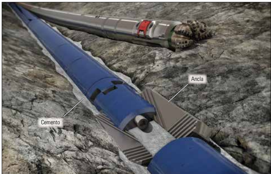
^ Desviación de la trayectoria después del bombeo de cemento. Con el ancla en su lugar, el sistema TrackMaster OH-C permite a los perforadores desviar la trayectoria del pozo sin tener que esperar que cure el cemento.
