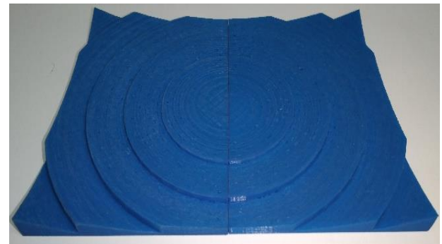
Figura 3 Superficie de revolución impresa en 3D con material PLA Fuente: Elaboración Propia
