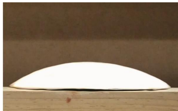
Figura 1 Formación de la superficie de sulfato de calcio generada por acción de la gravedad
