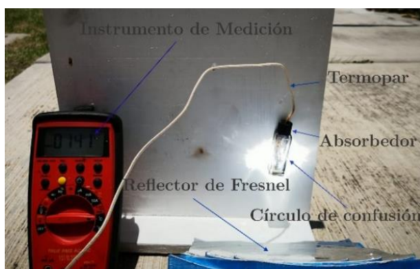
Figura 5 Pruebas del modelo impreso en 3D de temperatura a una DFE en el punto de concentración de la radiación solar Fuente: Elaboración Propia
