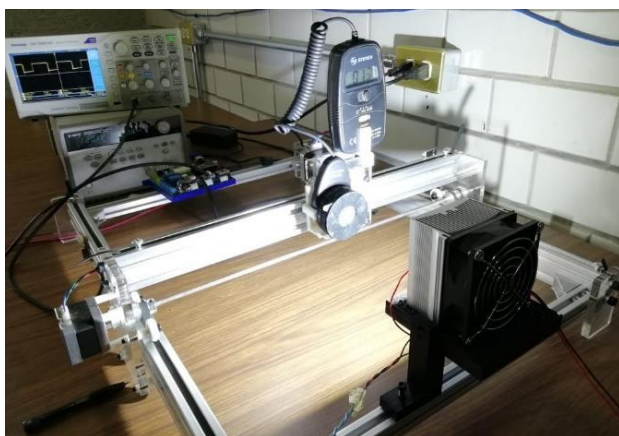
Figura 2 Representación del arreglo experimental de las primeras pruebas con LED de alta potencia (100W) con un fotodetector digital (Luxómetro)
