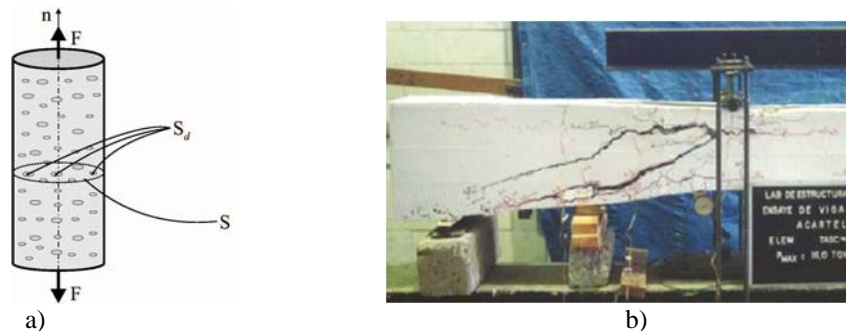
Figura 1 Proceso de daño en un medio continuo. a) inicio del daño a nivel micro-escala y b) evolución de las macro-grietas
