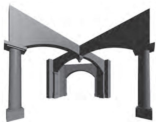
Figura 4 Modelo tridimensional de la solución de arcos dobles en la esquina del Palacio de la Inquisición (Elaborado por A. Contreras)
