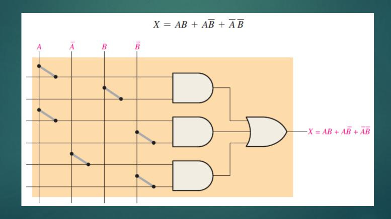
PAL (Programmable Array Logic) y GAL (Generic Array Logic) tienen varias entradas y varias salidas.
