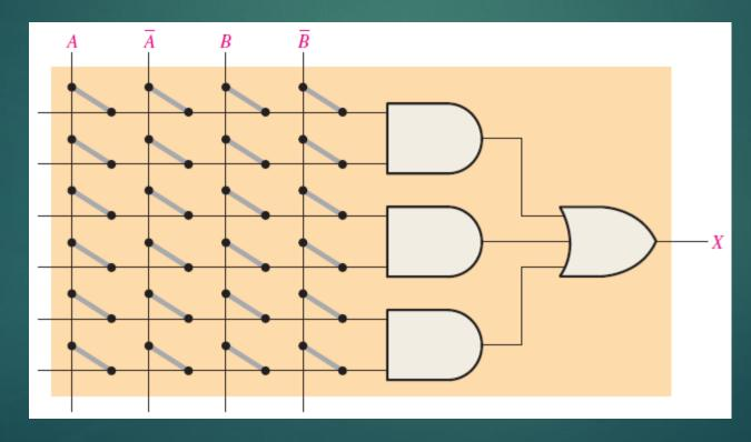
Es esencialmente una matriz o rejilla de conductores que forman filas y columnas con un enlace (unión) programable en cada punto de cruce. Cada unión programable, se llama celda.
