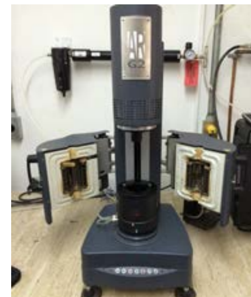
Figura 1. Reómetro con una geometría de cilindros concéntricos.
