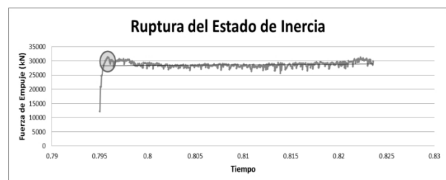
Figura 16. Ruptura del estado de inercia durante el avance de escudo.
