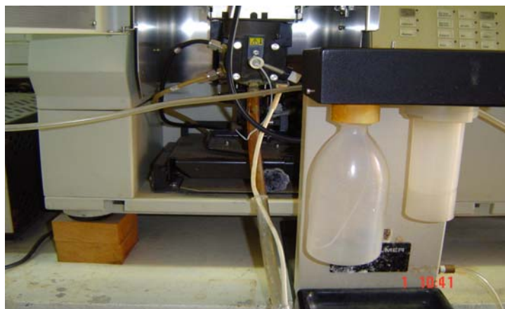
Figura III.6 Vaso de reacción del Espectrómetro de Absorción Atómica con Generador de Hidruros marca Perkin Elmer, modelo 3110.
