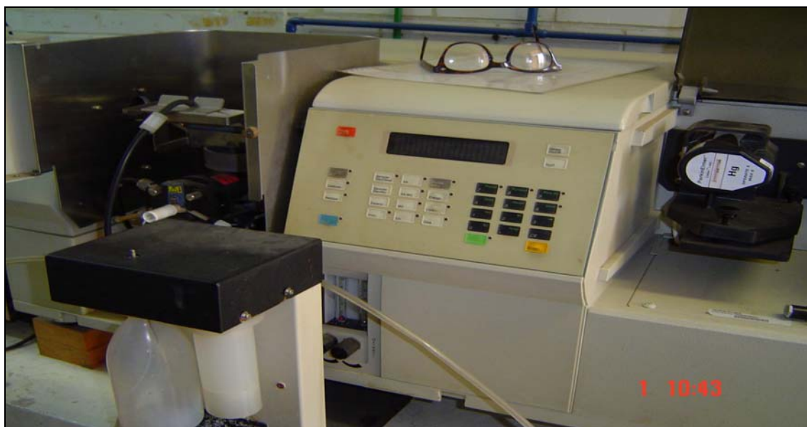
Figura III.2 Espectrofotómetro de Absorción Atómica con Generador de Hidruros marca Perkin Elmer, modelo 3110.
