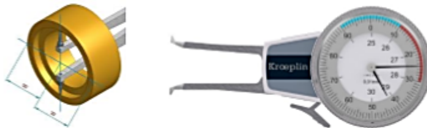
Figura 22. Determinación del diámetro de crimpado
