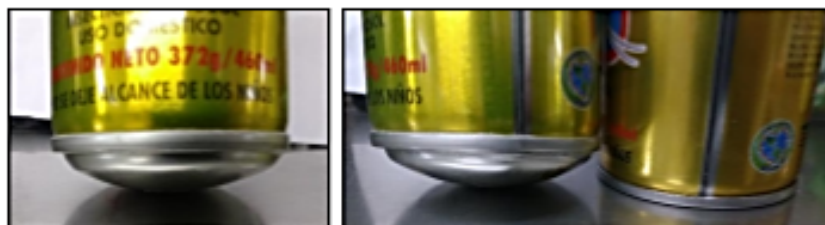
Figura 3 y 4. Ejemplo de expansión del envase por dilatación térmica del gas propelente.
