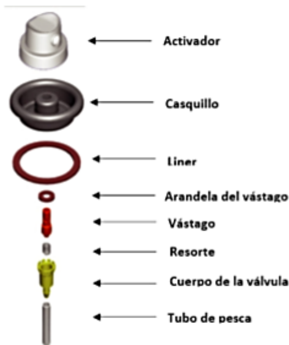
Figura 5. Partes de la válvula
