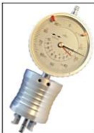
Figura 18. Instrumento mecánico para medir la altura de crimpado (Kroeplin)
