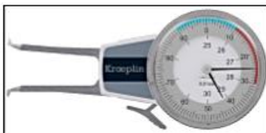
Figura 19. Instrumento mecánico para medir el diámetro de crimpado (Kroeplin)
