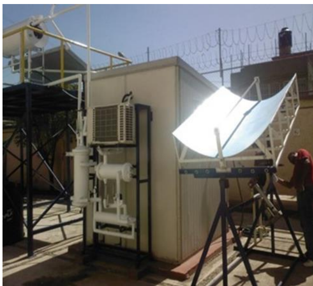
Figura 1 Concentrador parabólico cilíndrico experimental
