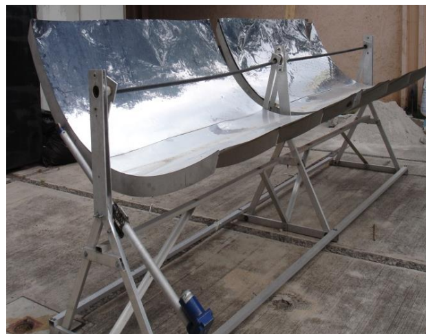
Figura 4 Prototipo final acoplado en la estructura diseñada
