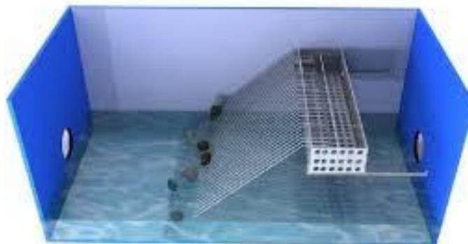
Figura 1. Rejas de desbaste manual. Obtenido de <http://blogdeagua.es/reja-de-desbaste/>
