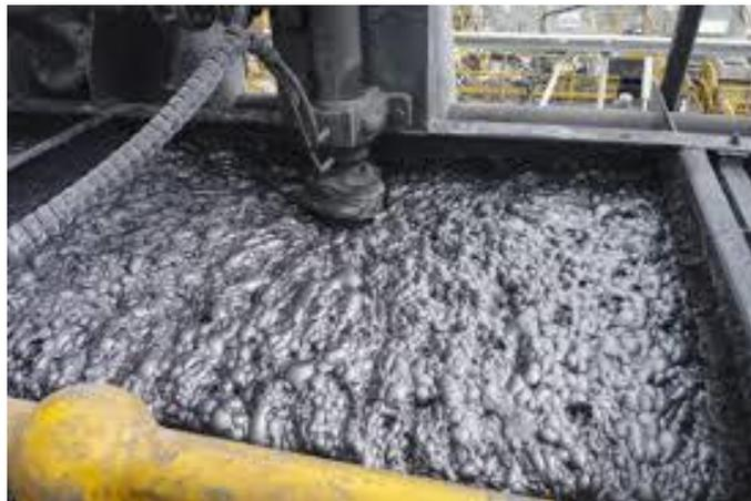
Figura 6. Flotación por aire. Obtenido de <https://eddyump.com/es/Educación/espuma-bombas-espuma-flotación-bombeo/>
