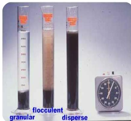
Figura 23. Ejemplos de los lodos encontrados en cada zona de un reactor UASB.
