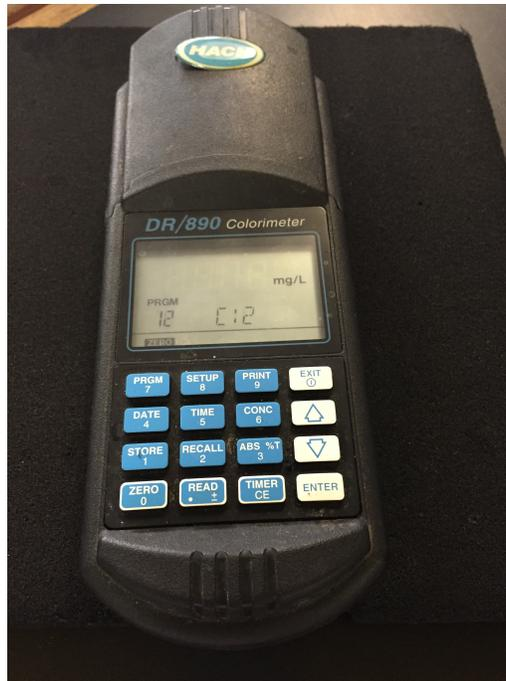
Colorímetro utilizado para la determinación de cloro en agua
