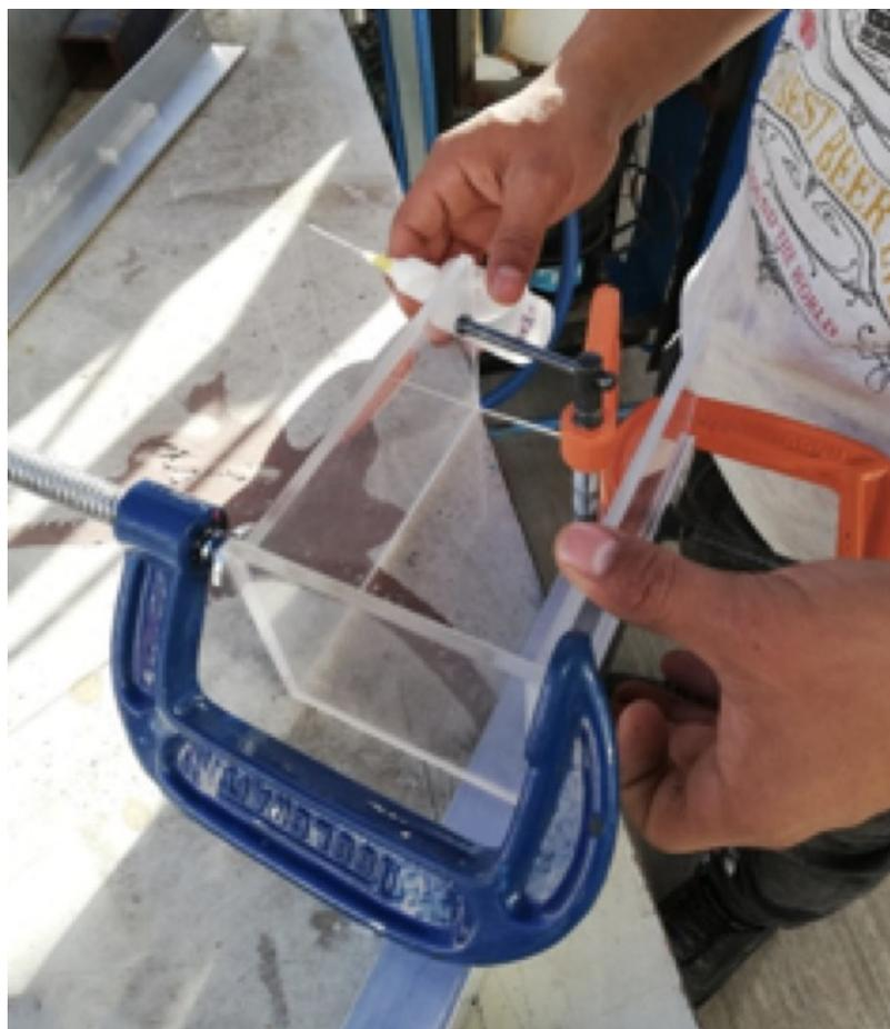
Figura 22. Ensamble del depósito del efluente
