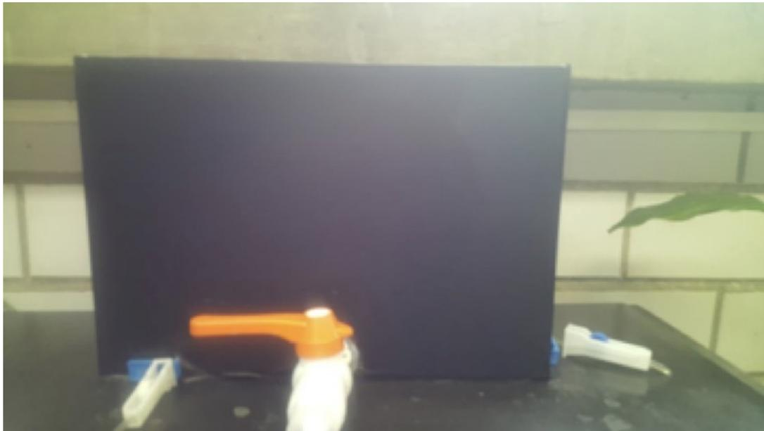
**Figura 36. Tanque de alimentación de agua residual**
