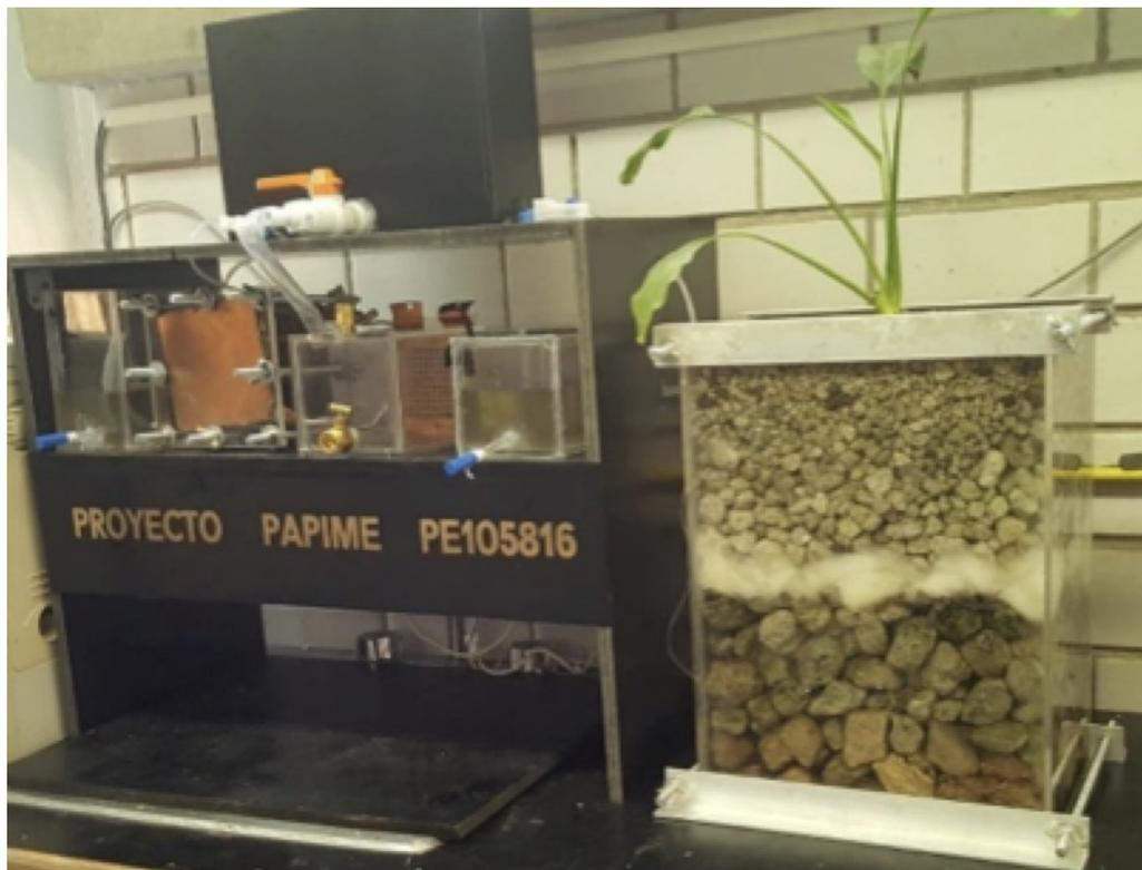
**Figura 58. Distribución de los tres tipos de celdas de combustible microbianas construidas mediante el proyecto PAPIME**
