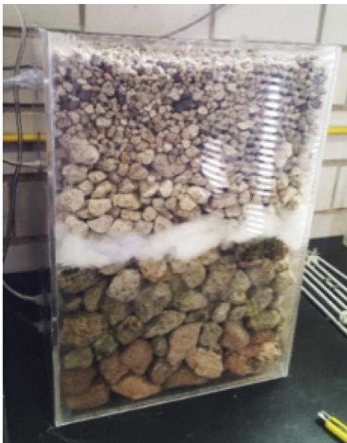
**Figura 32. Sustrato en orden granulométrico con electrodos y membrana colocada**
