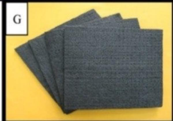
Figura 18. Materiales usados como ánodo en las CCM. (A) Varilla de grafito en una cámara sencilla de una CCM. (B) Escobillón de grafito. (C) Escobillón de grafito en una cámara de la CCM. (D) Tela de carbono. (E) Papel carbón. (F) RVC (G). Filtro de carbono. Imagen obtenida de Zhou *et al.*, 2011.
