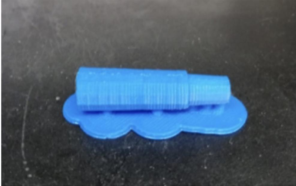
**Figura 37. Impresión 3D del tapón del tanque contenedor de agua tratada**
