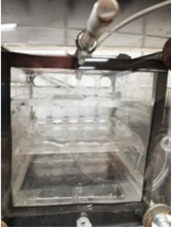
**Figura 24. Prueba de impermeabilidad del depósito y de la cámara de la celda**
